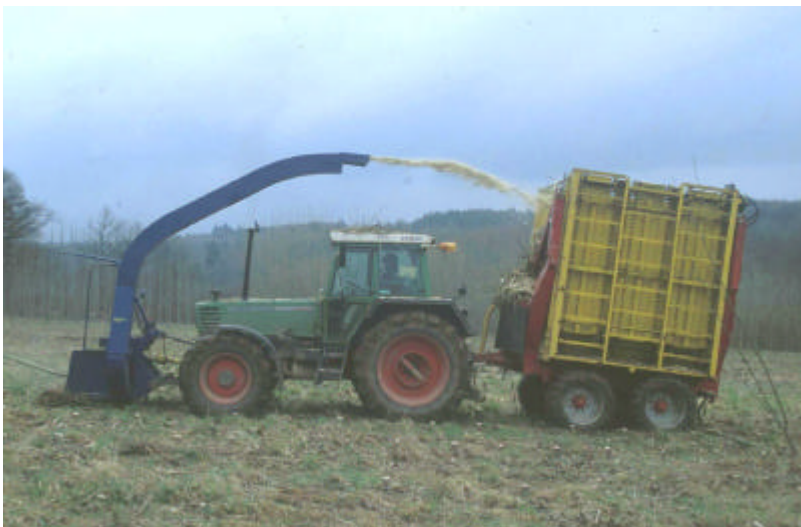
Abbildung 8: Göttinger Mähacker für die Ernte von schnellwachsenden Baumarten im Kurzumtrieb
