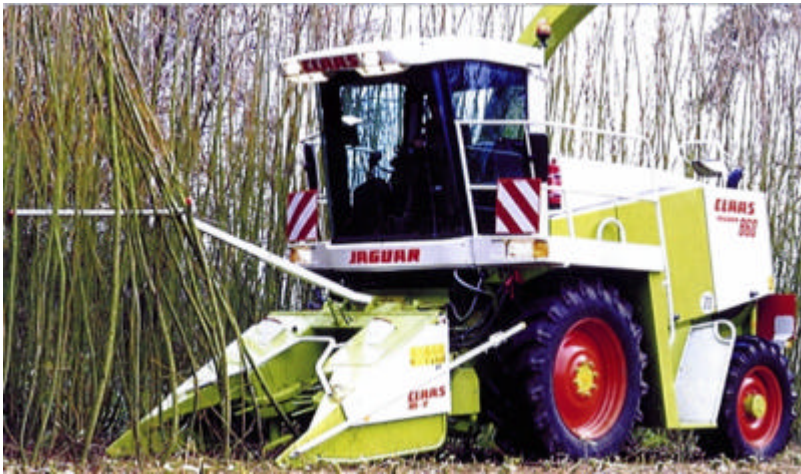
Abbildung 7: Claas Mähhäcksler zur Ernte von schnellwachsenden Baumarten im Kurzumtrieb
