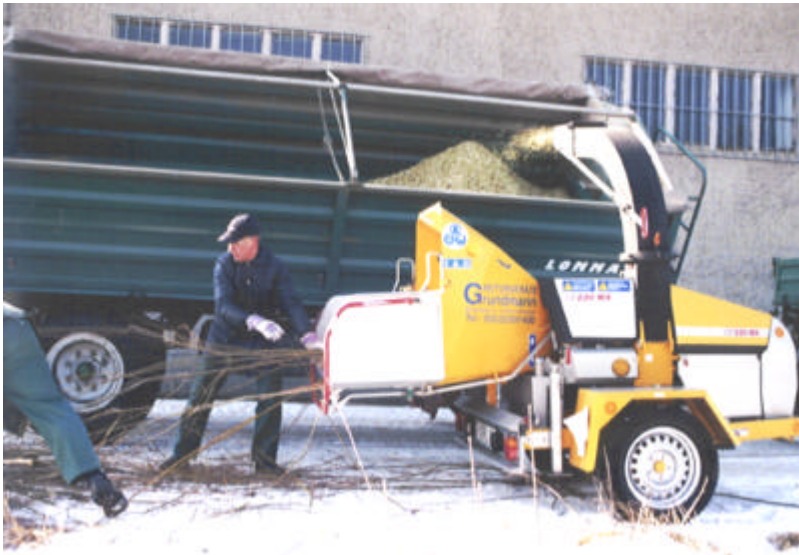
Abbildung 6: Aufbereitung von Kurzumtriebsholz zu Hackschnitzeln durch Anhängenhacker - motormanuelles Verfahren
