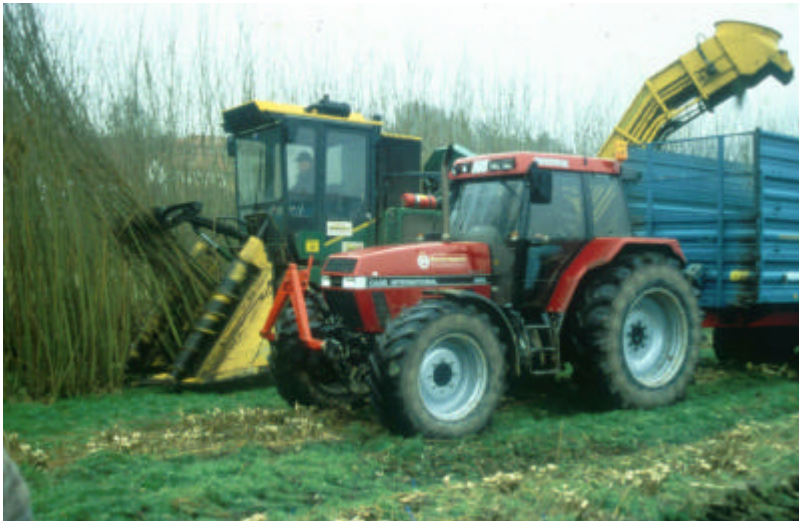
Abbildung 9: Selbstfahrhäcksler AUSTOFT 7700 zur Ernte von schnellwachsenden Baumarten im Kurzumtrieb
